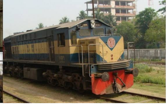
চিত্র-১.৪: বর্তমান ডিজেল ইলেকট্রিক লোকোমোটিভ (ইউনিভার্সেল টাইপ)
