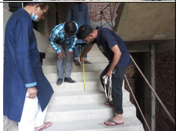
চিত্রঃ ভবনের ডিজাইন পর্যালোচনা, ভৌত অবস্থা পরিদর্শন, হল রুম, সিঁড়ি এবং প্লিন্থ এরিয়া পরিমাপ, হ্যামার টেস্ট
