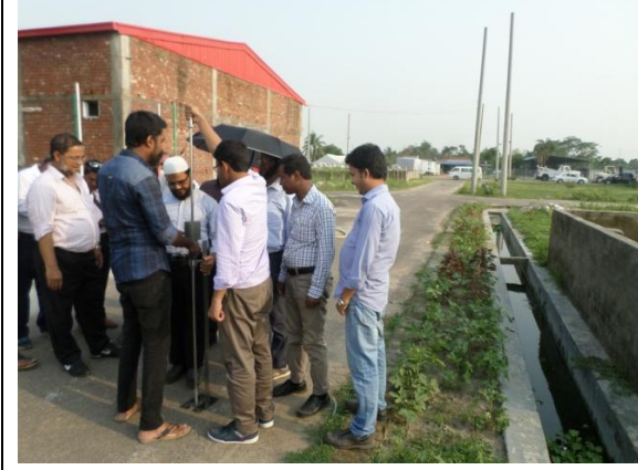
চিত্রঃ রাস্তার DCP Test ও রাস্তা পরিবীক্ষণ
