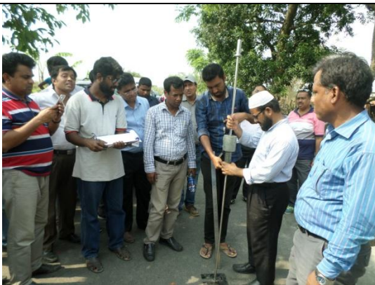
চিত্রঃ রাস্তার DCP Test ও রাস্তা পরিবীক্ষণ
