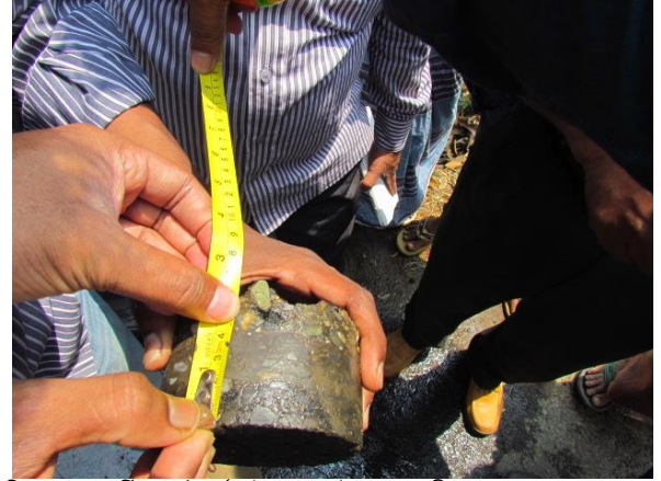
চিত্র: বিটুমিনাস পেভমেন্টের পুরুত্ব পরিমাপ এর জন্য কোর কাটিং এবং পরবর্তীতে মাঠ পর্যায়েই পেভমেন্টের পুরুত্ব পরিমাপ
