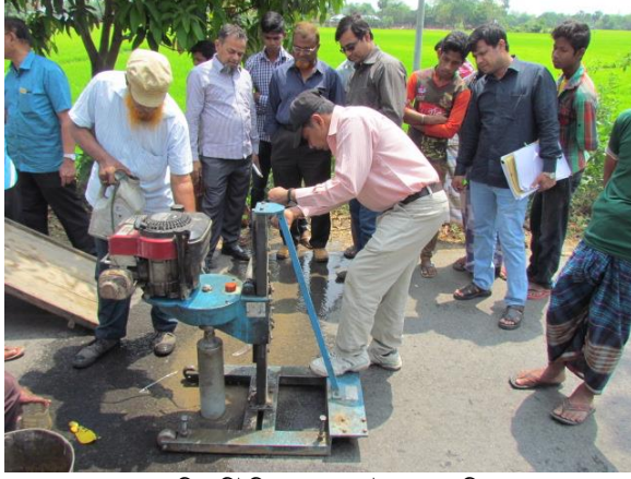
চিত্র: বিটুমিনাস পেভমেন্টের পুরুত্ব পরিমাপ এর জন্য কোর কাটিং এবং পরবর্তীতে মাঠ পর্যায়েই পেভমেন্টের পুরুত্ব পরিমাপ
