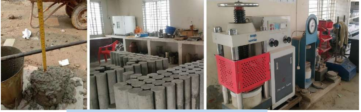
চিত্র ৩.১০: Slump Test এবং ঠিকাদারের Material Lab
