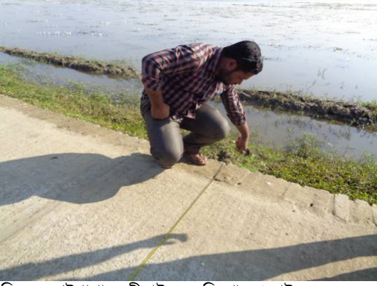
চিত্র ২: আটপাশা ফেরীঘাট হতে সিংগা লঞ্চঘাট সড়কের প্রশস্ততা ও আরসিসির পুরুত্ব মাপা হয়।
