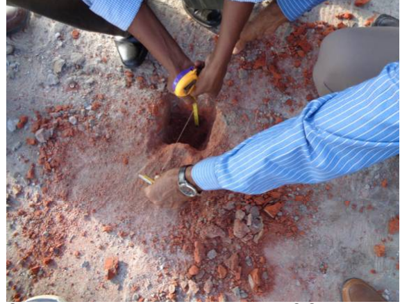
চিত্র-১১: এপ্রোচের কোর কাটিংর মাধ্যমে আরসিসির পুরুত্ব মাপা হয়।
