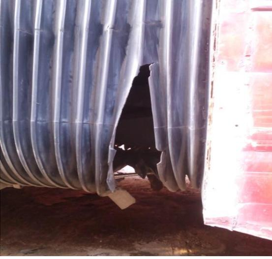
চিত্র ১: সংগৃহীত আর্টিকুলেটেড বাসের ভাঙ্গা Air Bellows
