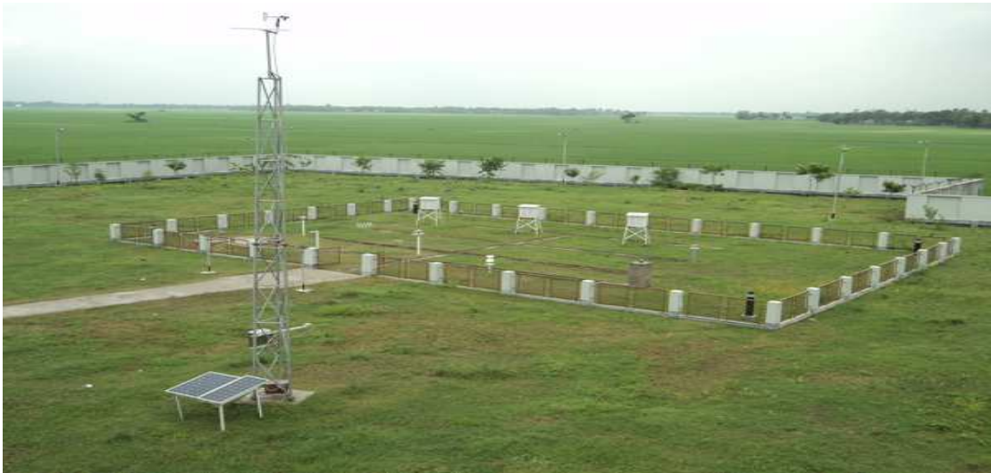
চিত্র : ৩ ইকুইপমেন্ট এনক্রোজার এর মধ্যে রক্ষিত আবহাওয়া পর্যবেক্ষণের জন্য নির্মিত বিভিন্ন ধরনের যন্ত্রপাতি।
