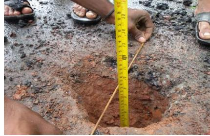
চিত্র-৩, ৪, ৫ ও ৬: পেভমেন্টের উপর পানি জমে থাকা, কিনারা ভাঙ্গা, পেভমেন্টের প্রশস্ততা কম হওয়ায় গাড়ির চাকার চাপে সফট শোল্ডার ক্ষয় ও পেভমেন্টের thickness পরীক্ষা
