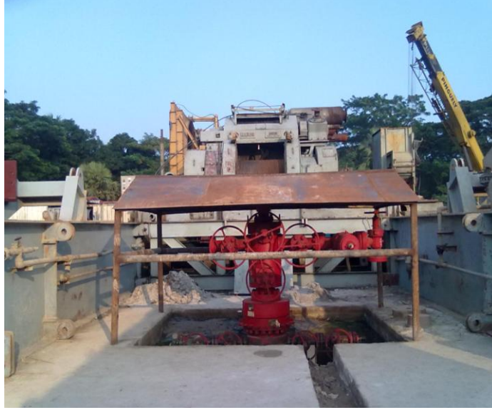
চিত্র:২ কূপ খনন ও পরীক্ষণ শেষে ভালভ/ফিটিংস সম্বলিত কূপের X-mass Tree
