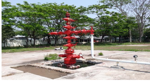
চিত্র-৩: ভোলার শাহবাজপুর গ্যাস ক্ষেত্রের ১ নম্বর কূপের ক্রিসমাসট্রি।
